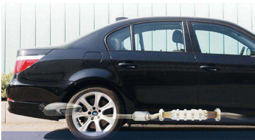
Figura 4.5 - Vista lateral dos módulos termoelétricos instalados junto ao escapamento. (BMW, 2009)
