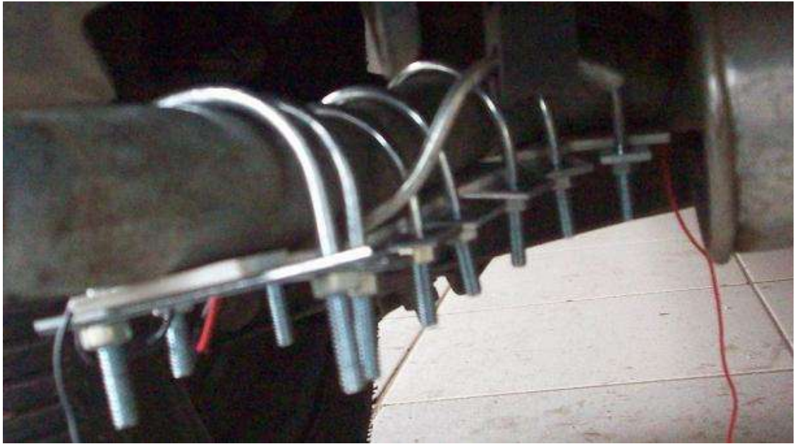
Figura 3.10 - Sistema de captação instalado no veículo.
