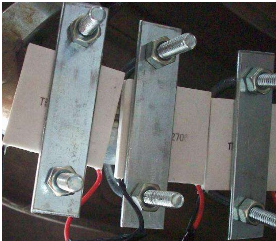
Figura 3.11 - Sistema de captação instalado na parte final do escapamento.
