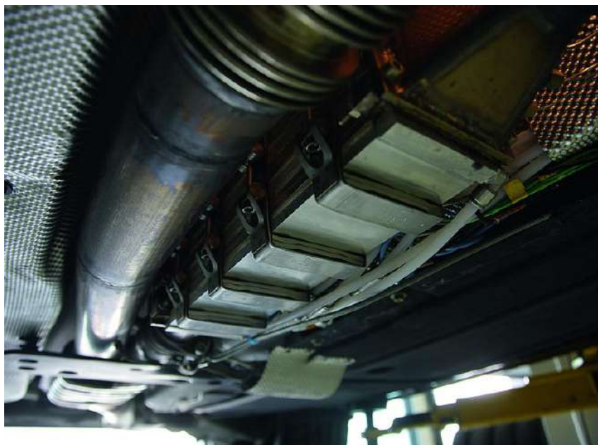
Figura 4.4 - Módulos Termoelétricos instalados junto ao tubo do escapamento. (BMW, 2009)
