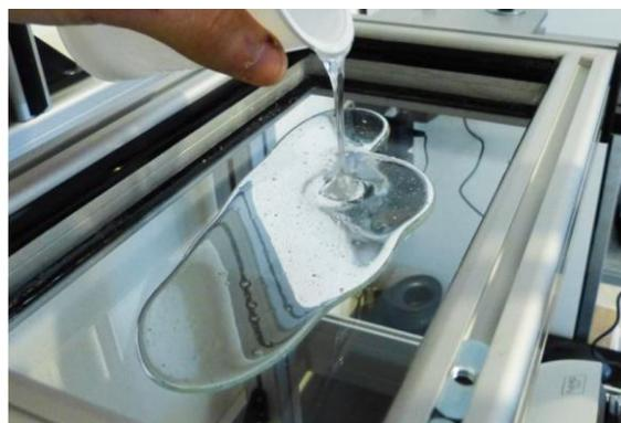
Figura 20: Silicone sendo depositado no tanque de resina
