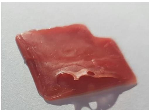
Figura 32: Peça obtida no segundo teste realizado na impressora. Escala 2:1.
