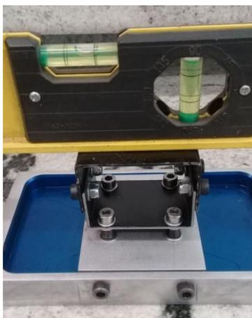
Figura 36: Verificação do desnível da plataforma.
