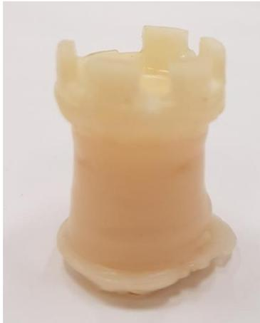
Figura 43: Torre impressa após a calibração. Escala 1,5:1.
