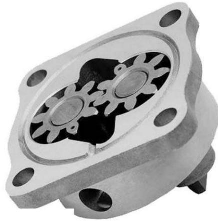
Figura 4.1: Bomba de óleo para motor de *Fusca*.
