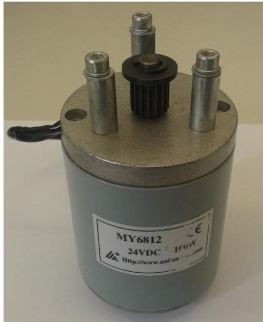
Figura 3.4: Motor utilizado para o agitador (ARAÚJO, 2015).
