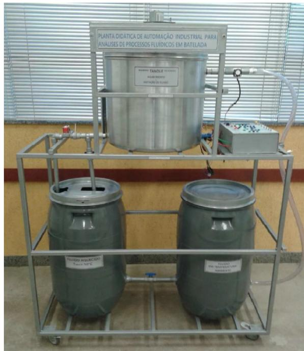
Figura 3.1: Planta didática de automação industrial para análise de fluido em batelada (ARAÚJO, 2015).
