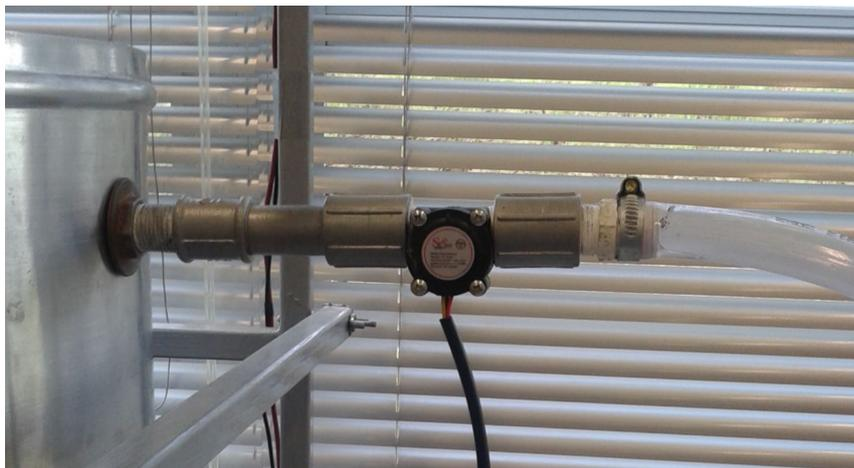
Figura 3.6: Sensor de vazão na planta didática (ARAÚJO, 2015).
