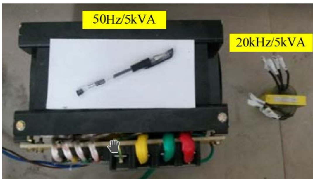
Figura 3.3 – Comparativo de tamanho entre um transformador convencional de 50 Hz e outro de 20 kHz feito em ferrite e com a mesma potência nominal.
