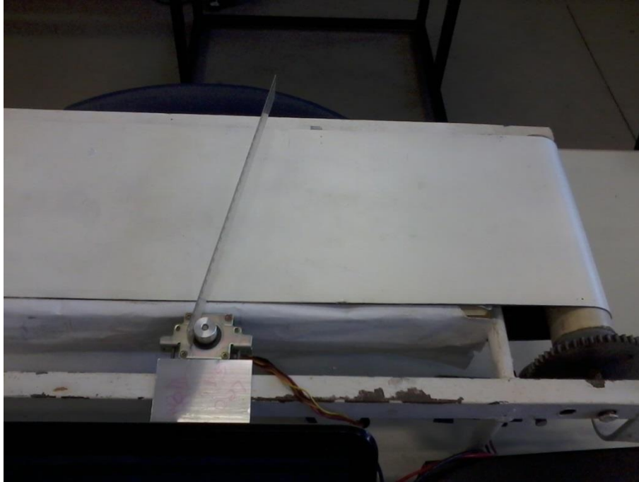
Figura 3.6 - Lamina de plástico acoplada ao dispositivo com função de barrar objetos indesejáveis.
