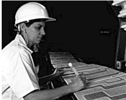
Figura 1.2 - Exemplo de inspeção manual na indústria de cerâmica (STIVANELLO, 2004)
