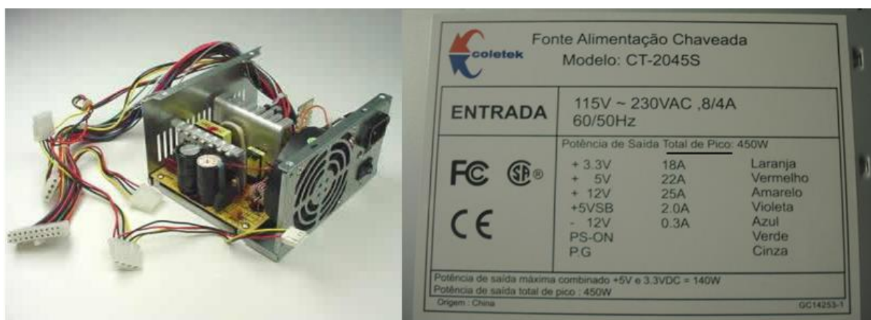
Figura 3.10 – Imagem representativa da fonte utilizada para alimentar o motor da esteira (GUIMARÃES, 2012)
