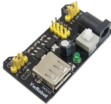
Figura 3.19: Fonte Ajustável 3.3V 5V para Protoboard MB102
