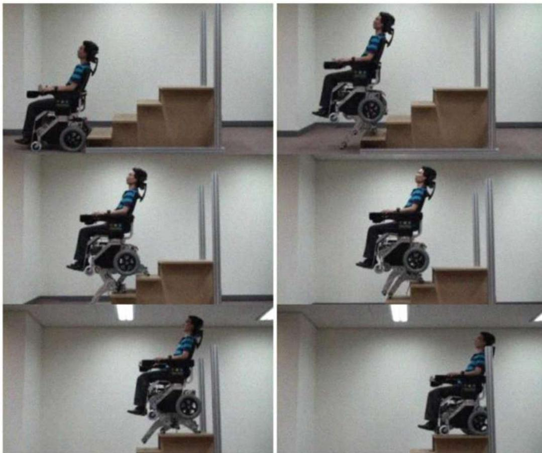
Figura 2.1: Protótipo de cadeira de rodas com um mecanismo de duas pernas para subir escadas (Bang et al., 2011).
