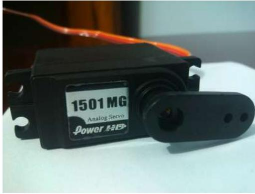
Figura 4.4: Servomotor usado para posicionamento do sensor ultrassônico e para a abertura da rampas.
