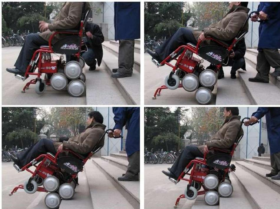
(b) Protótipo desenvolvido em funcionamento.
