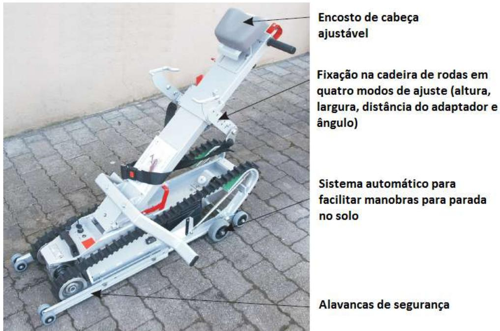
Figura 2.6: Esteira que pode ser acoplada à cadeira de rodas para torná-la capaz de subir escadas. Adaptado de Peter Auer GmbH (*n/d*).
