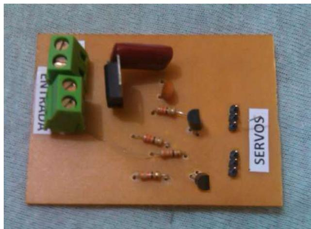
Figura 4.6: Placa para acionamento dos servomotores de 6V.
