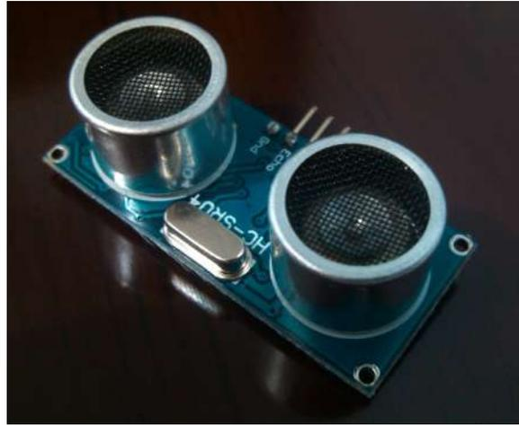
Figura 5.1: Sensor ultrassônico usado no trabalho.
