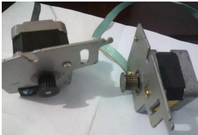
Figura 4.3: Motores de passo reaproveitados de impressoras antigas.
