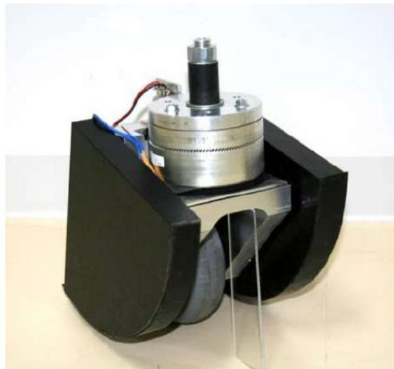
Figura 2.4: Visão geral da roda dianteira que permite à cadeira transpor pequenos obstáculos (Yokota et al., 2011).
