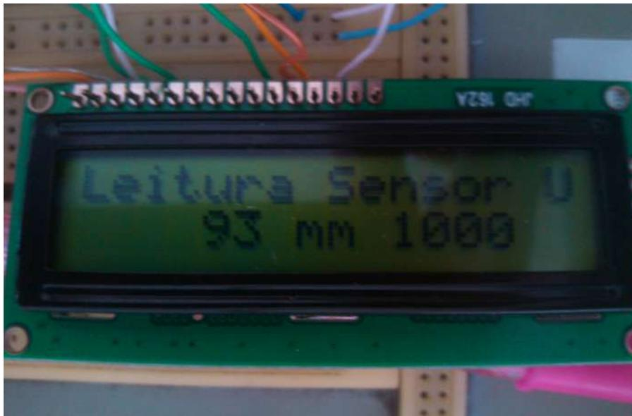
Figura 5.4: *Display* LCD indicando a leitura do sensor ultrassônico em mm.
