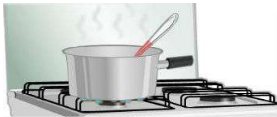
Figura 2.12: Processo de condução térmica TODA MATERIA 3
