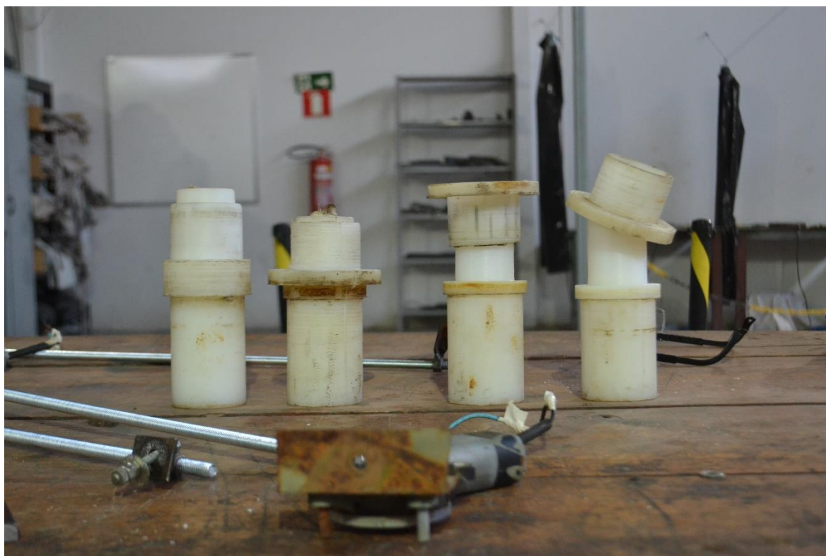
Figura 3.12: Buchas com movimentação relativa entre si
