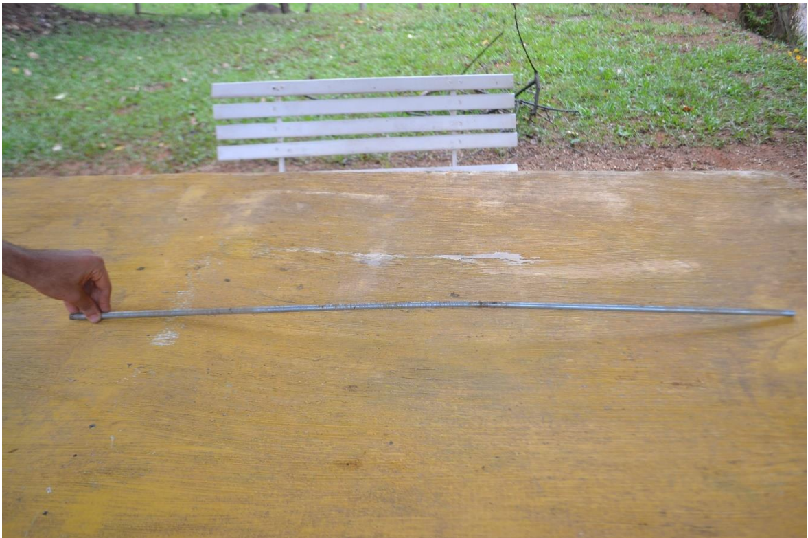
Figura 4.7: Barra fletida após os testes acelerados.
