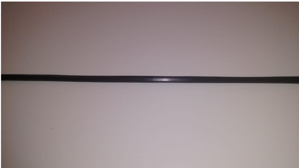
Figura 35: Filamento produzido com material com baixa taxa de umidade.
