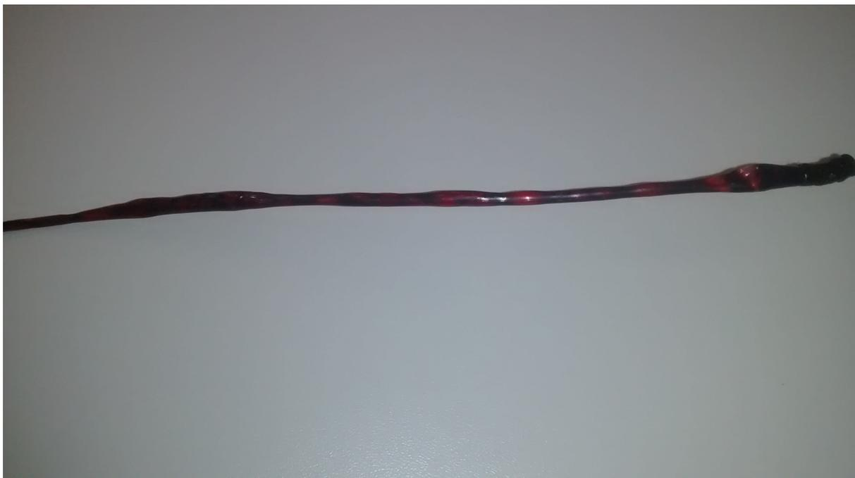
Figura 33: Filamento produzido com material com alta taxa de umidade.
