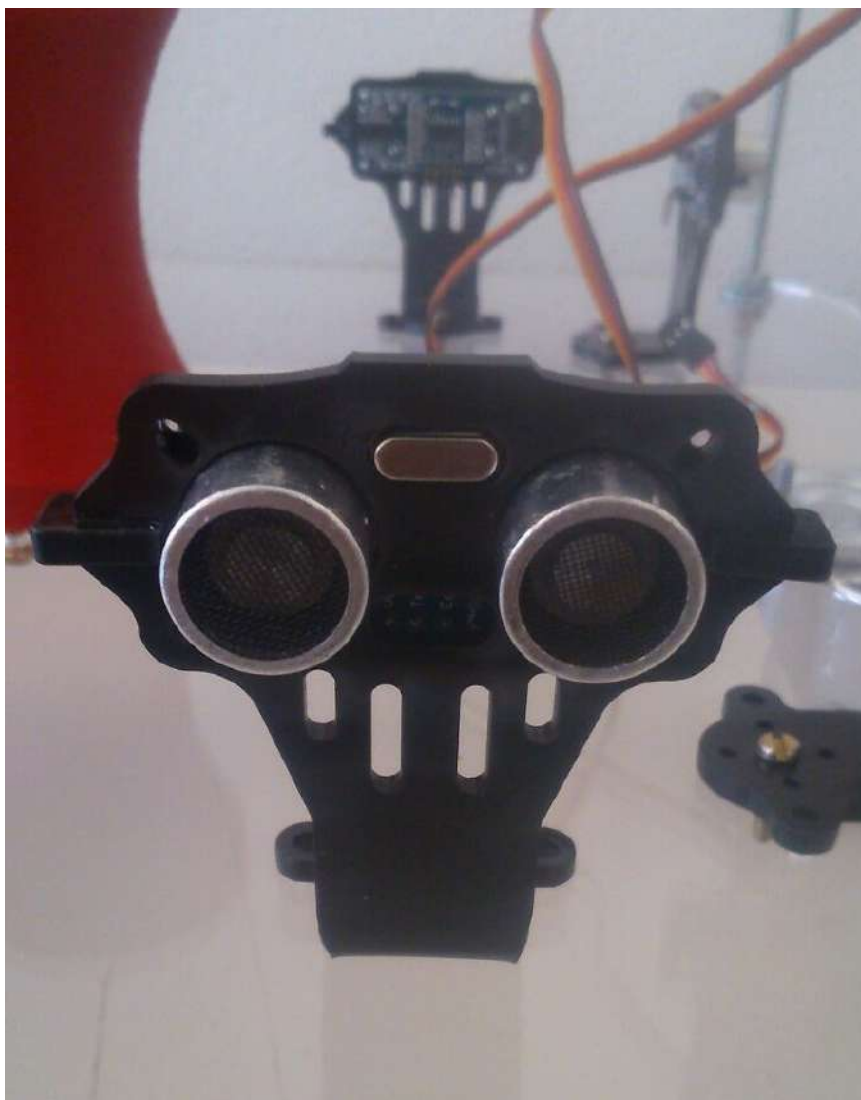
Figura 4.5: Sensor ultrassom montado em seu suporte fixado à base do robô.
