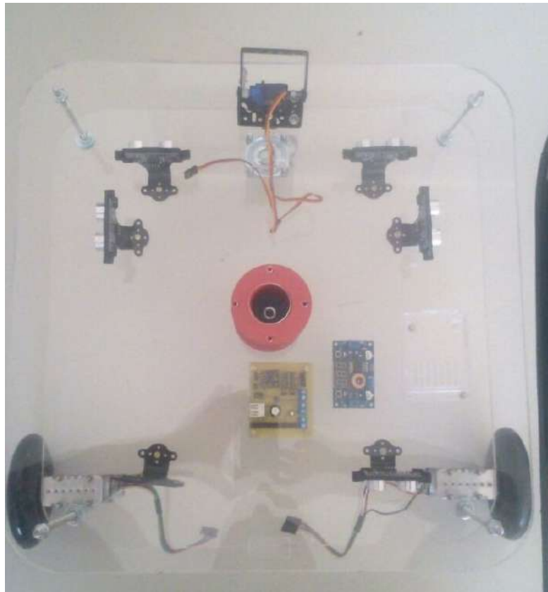
Figura 4.6: Vista superior da base do robô evidenciando a configuração espacial dos sensores ultrassom.
