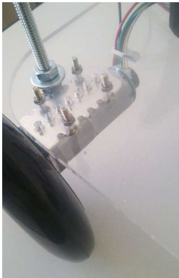
Figura 4.8: Fixação do motor e seu suporte à plataforma inferior do robô.
