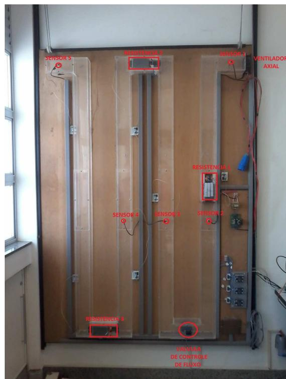
Figura 3.2: Distribuição dos sensores e atuadores na planta.
