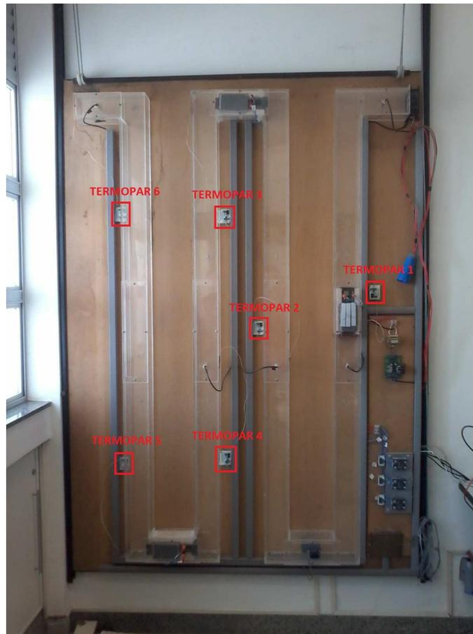
Figura 3.16: Disposição dos Termopares na planta.
