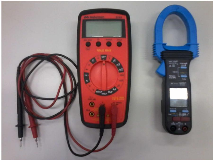
Figura 3.5: Multímetro Digital e Alicete Amperímetro utilizados na obtenção da Potência Máxima.
