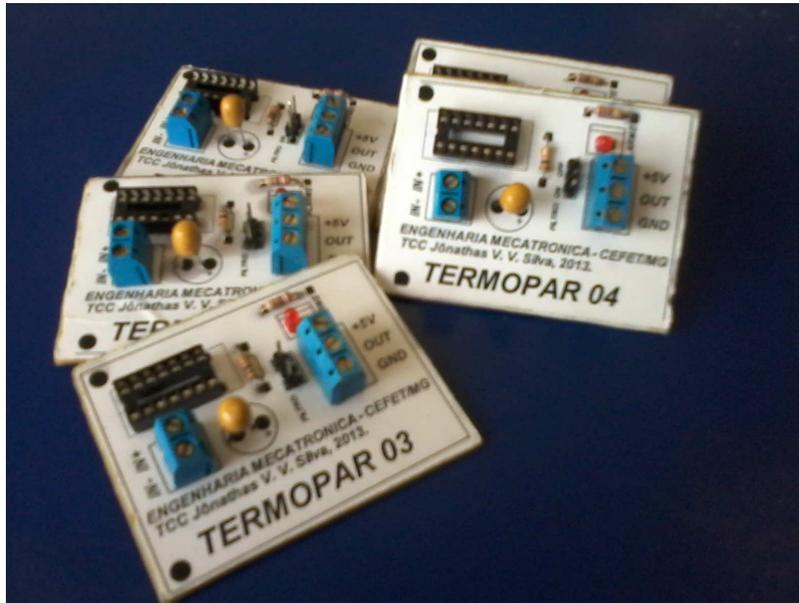
Figura 3.7: Circuitos Termopares
