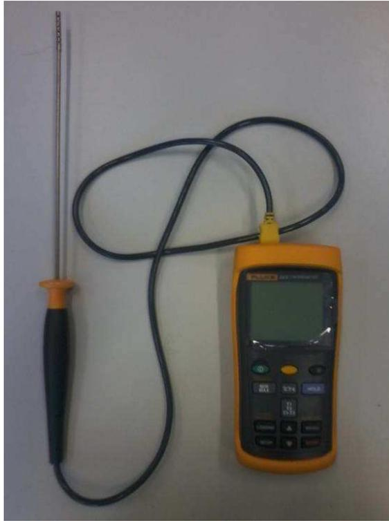
Figura 3.8: Termômetro Digital e sonda para fluxo de ar utilizados na calibração.
