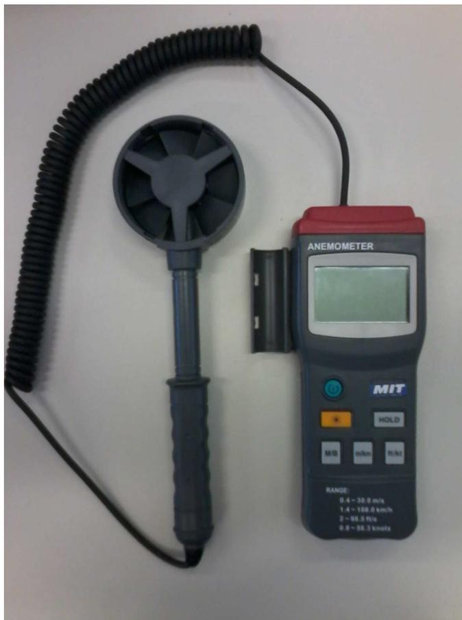
Figura 3.22: Anemômetro digital utilizado para medir a velocidade do fluxo de ar.
