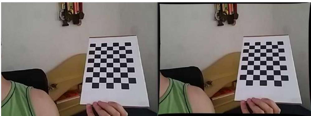
Figura 3.22: Comparação da imagem original e a mesma com correção da distorção
