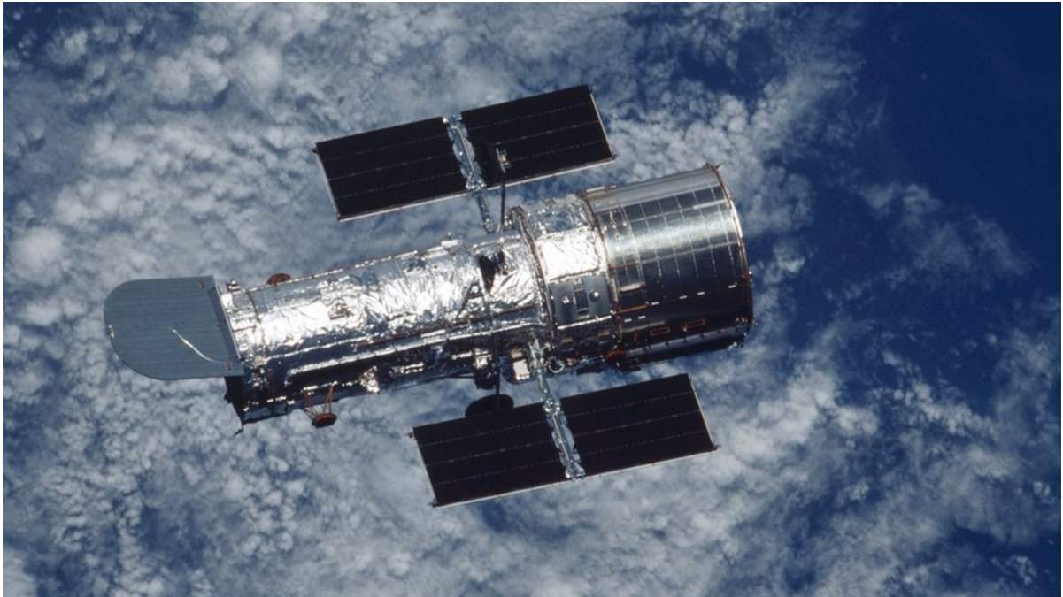
Figura 2.1: Telescópio Hubble utilizando painéis solares Fonte: Nasa/BBC
