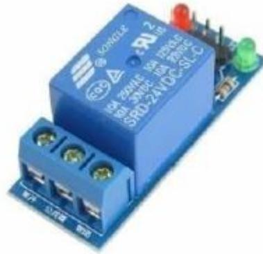
Figura 1.4: Módulo relé para *Arduino* (SARTO, 2018)
