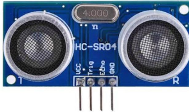
Figura 2.8: Sensor ultrassônico HC-SR04 (ENSMINGER; BOND, 2011)
