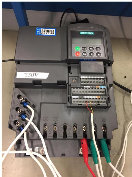
Figura 2.7: Inversor de frequência *Micromaster 440*
