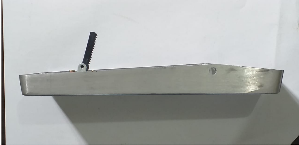
Figura 7.4: Vista Lateral com a régua dentada para mover o potenciômetro Fonte: (Arquivo pessoal do autor)
