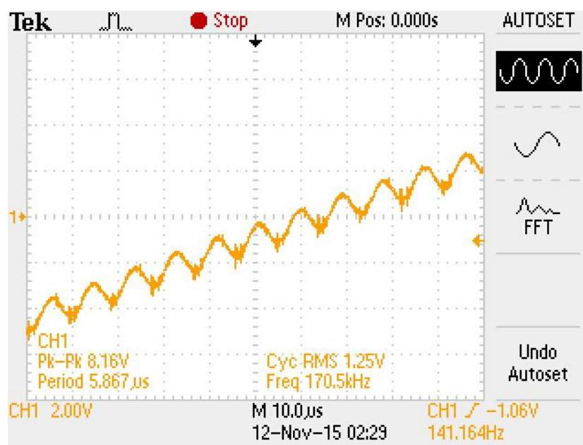
Figura 5.1 – Protótipo inicial: Sinal proveniente do gerador de sinais acoplado na rede elétrica.
