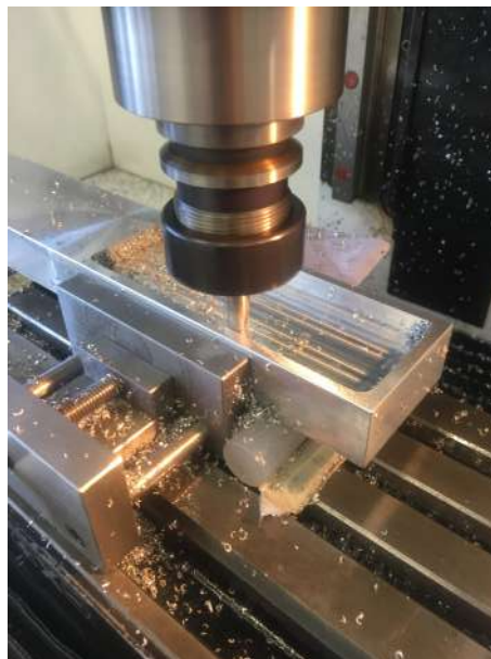
Figura 4.6: Fresadora CNC fabricando a base da ferramenta robótica.
