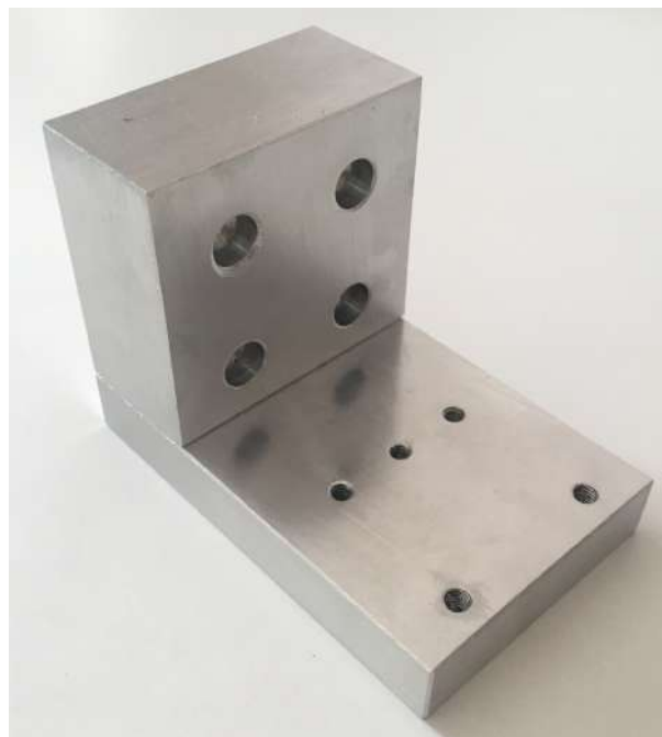
Figura 5.3: União das peças para acoplamento da ferramenta ao robô.
