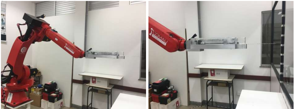
Figura 5.7: Ferramenta robótica desenvolvida acoplada ao robô industrial Comau Smart SiX.
