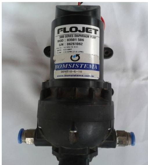
Figura 6.6. Bomba de circulação de água aquecida
