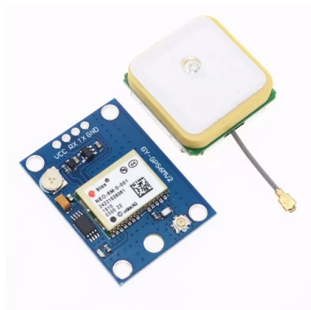
Figura 3.10: Módulo receptor GPS escolhido, GY-GPS6MV2.
