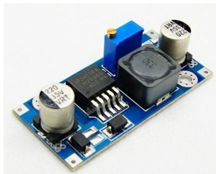
Figura 2.7: Módulo regulador de tensão, baseado no LM2596T.
