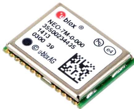
Figura 2.2: Circuito integrado NEO-7M.
