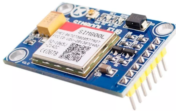
Figura 3.9: Módulo GSM escolhido, SIM800L V2 5V.
