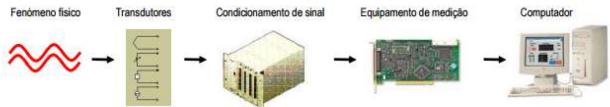
Figura 2.15: Diagrama funcional de um sistema de aquisição baseado num computador pessoal. Adaptado de (INSTRUMENTS, 2012).
