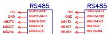
Figura 3.41: Conexão para comunicação cabeado RS-485.
