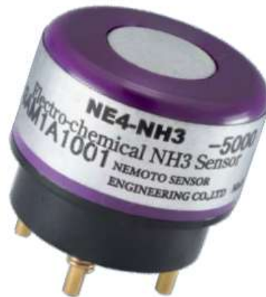
Figura 3.6: Sensor eletroquímico NE4-NH3. Adaptado do Datasheet em (ENGINEERING, 2016).
