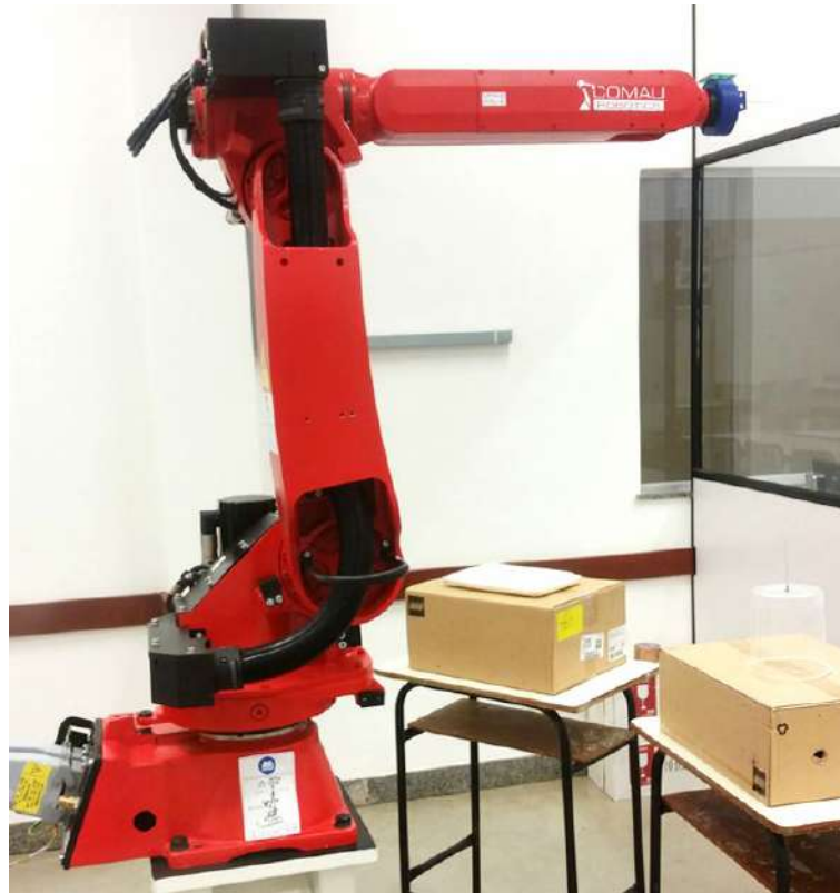
Figura 2.2: Robô industrial COMAU Smart5 SiX 1.4 do CEFET-MG / Campus Divinópolis
