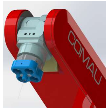
Figura B.1b: Aproximação da vista virtual da ferramenta sem o conjunto de lentes montado no robô em perspectiva
