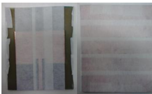
Figura 4.18 - Preparo da antena para nova corrosão.
