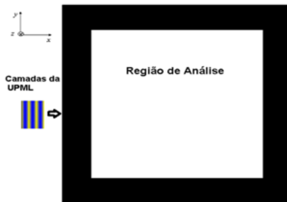
Figura 2.2 – Representação do espaço computacional, dividido em UPML e região de análise.
