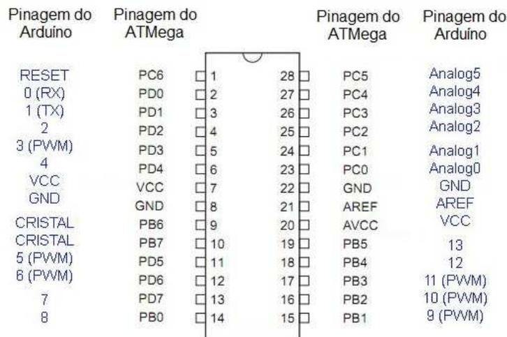
Figura 3.6: Equivalência de pinagem entre Atmega 328 e Plataforma Arduino.
