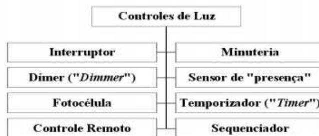
Figura 2.4: Diagrama com os diversos tipos de controle de iluminação (Adaptado de NISKIER, 2000).
