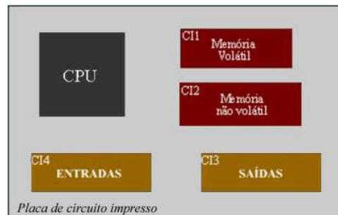
Figura 2.10: Partes básicas de um microcomputador (SILVA, CARVALHO, 2011).
