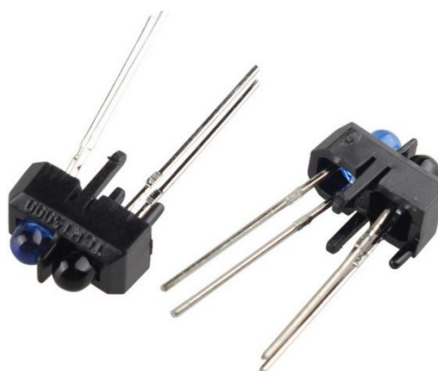
Figura 14 - Sensor Reflexivo Infravermelho TCRT5000.
