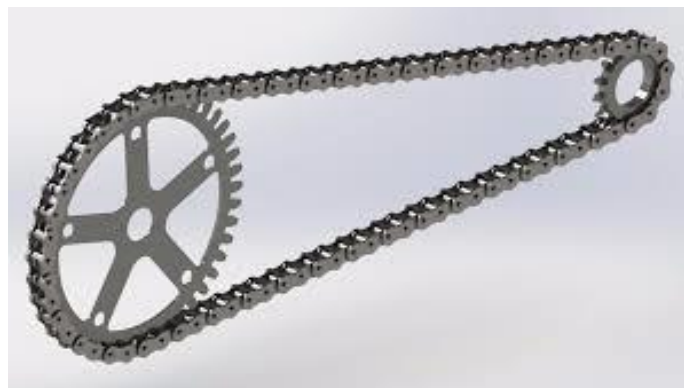
Figura 30 - Sistema de transmissão coroa-catraca.
