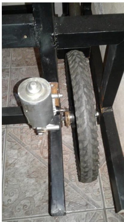
Figura 32 - Fixação do motor á estrutura.
