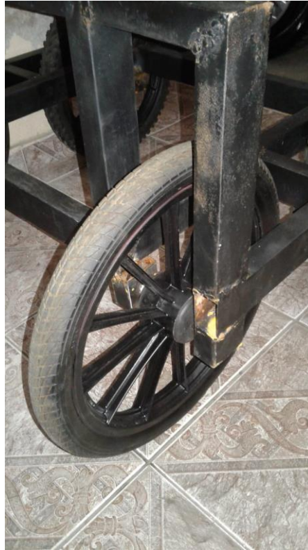
Figura 29 - Rodas na estrutura com mancais.
