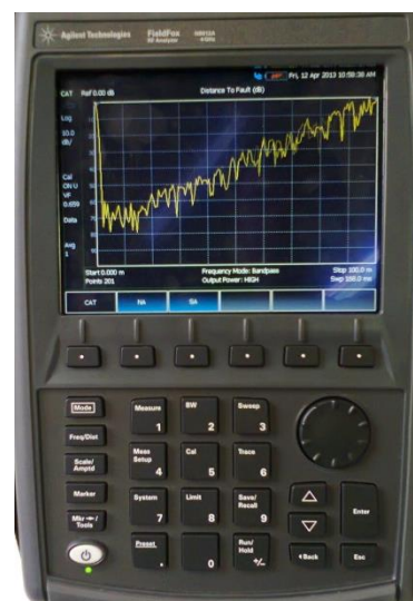
Figura 6.2: Analisador de espectro Agilent N9912A de 4 GHz.
