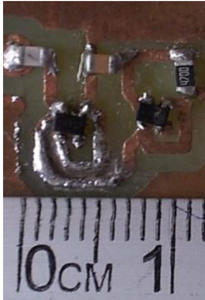
Figura 8.8: Circuito receptor construído usando BFP420 .
