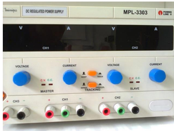
Figura 6.3: Fonte simétrica ajustável de tensão contínua Minipa MPL-3303.
