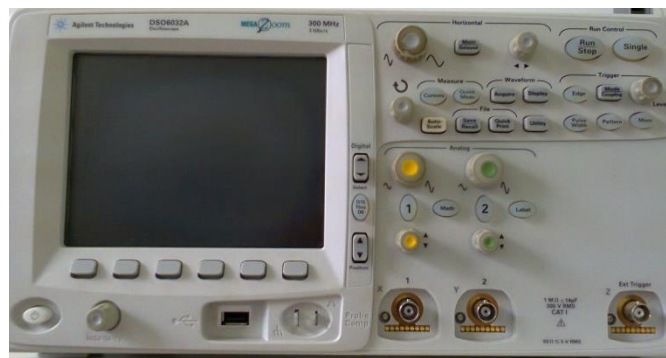
Figura 6.1: Osciloscópio Agilent DSO6032A de 300 MHz.
