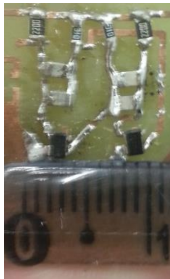
Figura 8.2: Circuito do oscilador de onda quadrada construído usando o transistor montado em superfície ( surface-mount device – SMD) BFP420 da Infineon.
