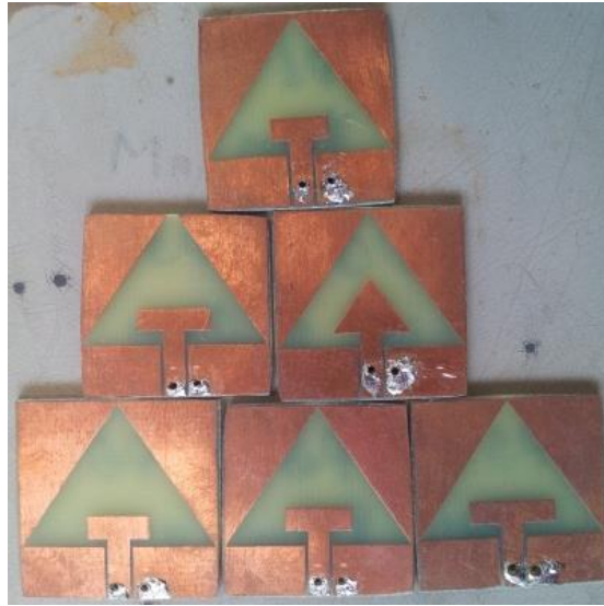
Figura 8.6: Antenas desenvolvidas para diferentes valores de S e L .
