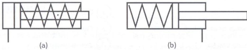
Figura 2.13: Representação Simbólica Normalizada Cilindro de Ação Simples (a) normalmente retraído com retorno por mola (b) normalmente distendido com retorno por mola (FIALHO, 2006)
