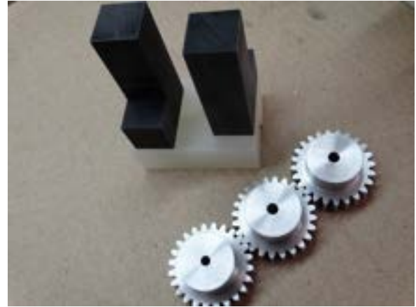
(b) Dedos da garra divididos em duas peças e conjunto de engrenagens.
