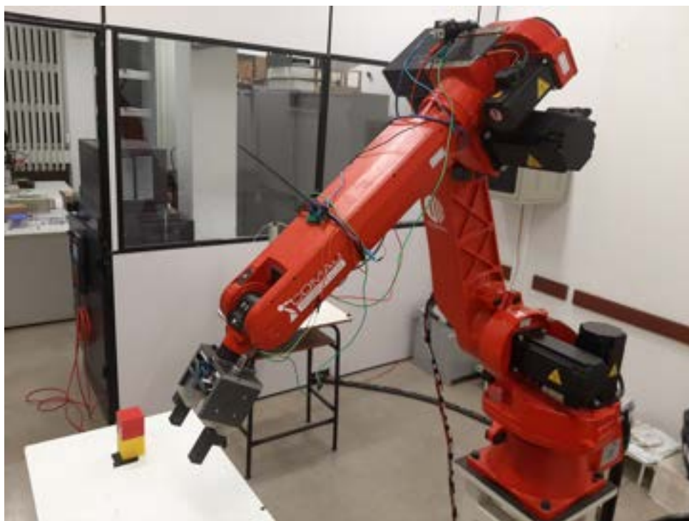
Figura 5.9 – Teste da ferramenta por uma tarefa estruturada de empilhamento de dois cubos.
