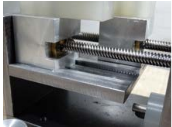
(b) Montagem dos blocos de suporte para castanha nos fusos.
