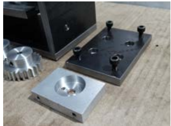
(b) Suporte para o motor e acoplamento para o flange.
