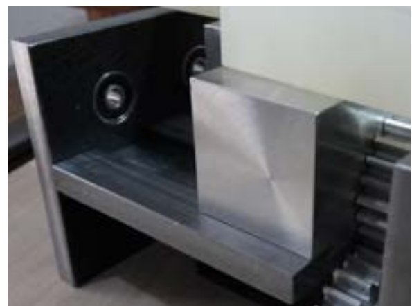
(b) Guia linear e fixação dos rolamentos.
