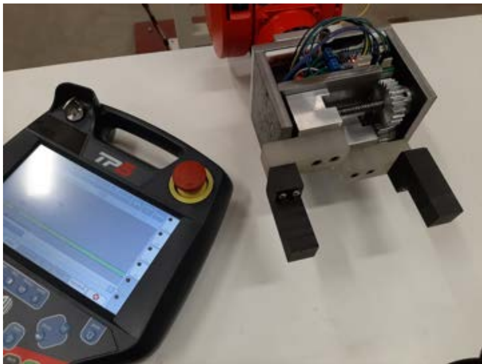
Figura 5.8 – Teste manual da comunicação entre a controladora e a garra.
