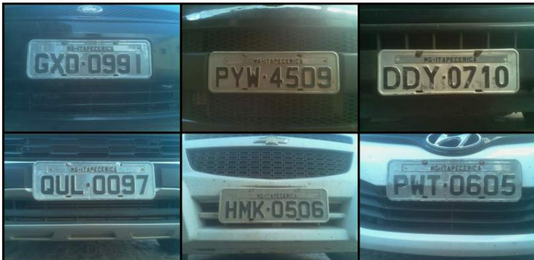
Figura 4.3: Imagens obtidas para testes de identificação completa de placas e caracteres pela versão do *hardware* desenvolvido.
