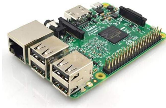
Figura 3.2: Raspberry Pi 3 Model B (Fonte: Amazon<sup>1</sup>).
