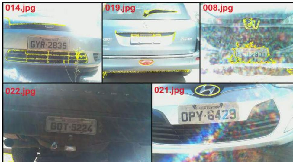
Figura 4.5: Resultados do algoritmo de identificação de placas em imagens contendo intensa luminosidade incidente diretamente na câmera.
