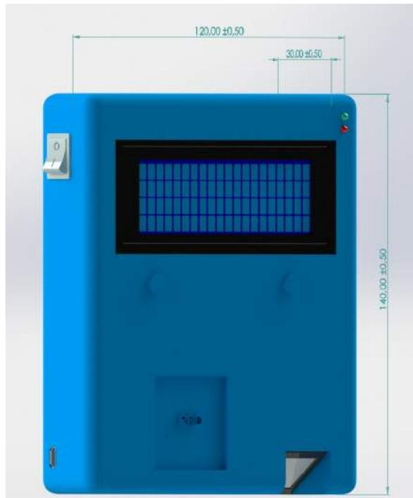
Figura 3.22: Desenho da case com as dimensões.
