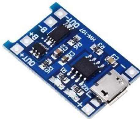
Figura 3.8: Módulo de carga TP5046. Fonte: MERCADO LIVRE
