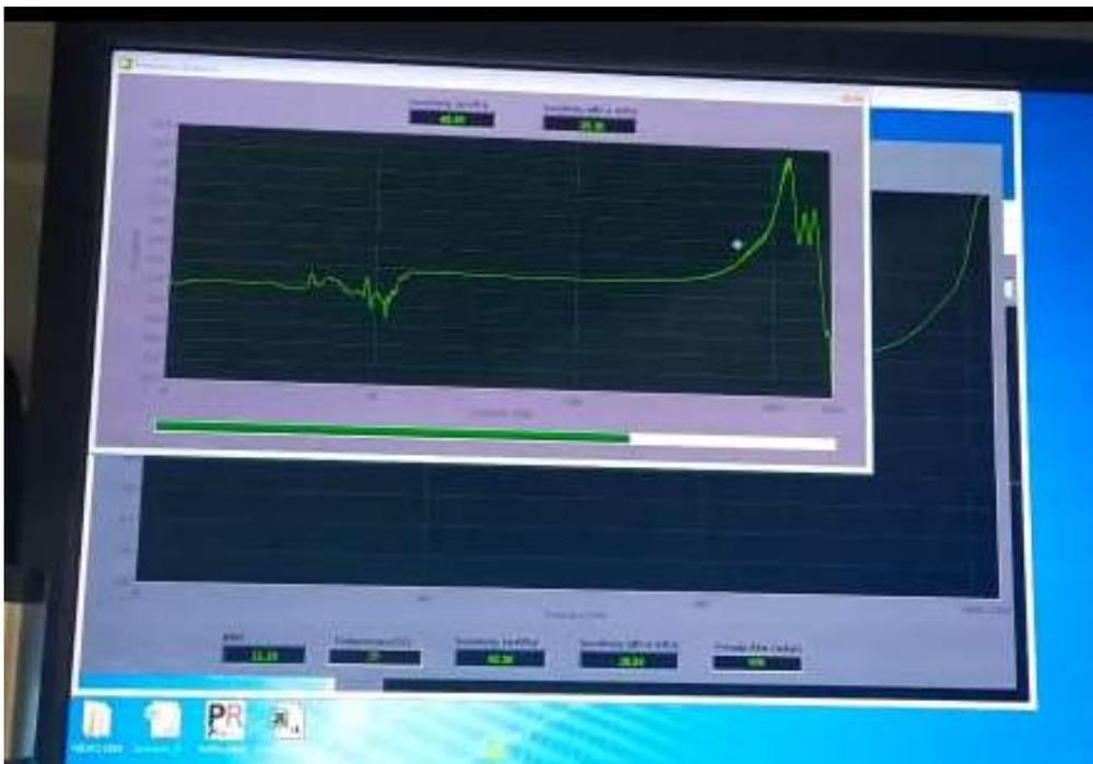
Figura 3.7: Curva de resposta em frequência do microfone em teste durante o *sweep* do gerador de sinais
