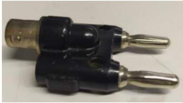
Figura A.20: Adaptador tipo "Banana - BNC"
