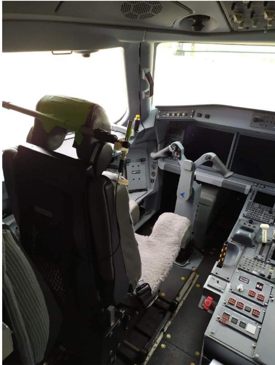
Figura 3.53: Posição do microfone no 1P do *cockpit*
