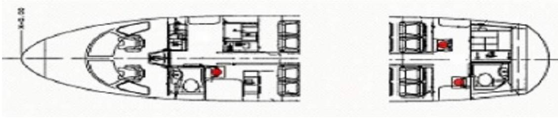
Figura 3.50: Posições dos microfones nas *galleys*
