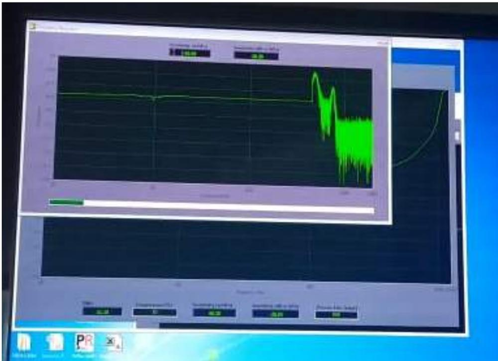
Figura 3.6: Curva de resposta em frequência do microfone em teste durante o *sweep* do gerador de sinais
