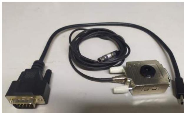
Figura A.15: Cabo de comunicação serial do Pistonphone com um conversor RS-232 para USB
