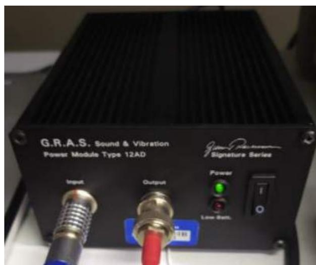
Figura A.2: Amplificador da *G.R.A.S Sound and Vibration*, modelo 12AD
