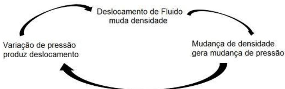
Figura 2.2: Ciclo da propagação de um onda. Adaptado de (NUSSENZVEIG, 2001)
