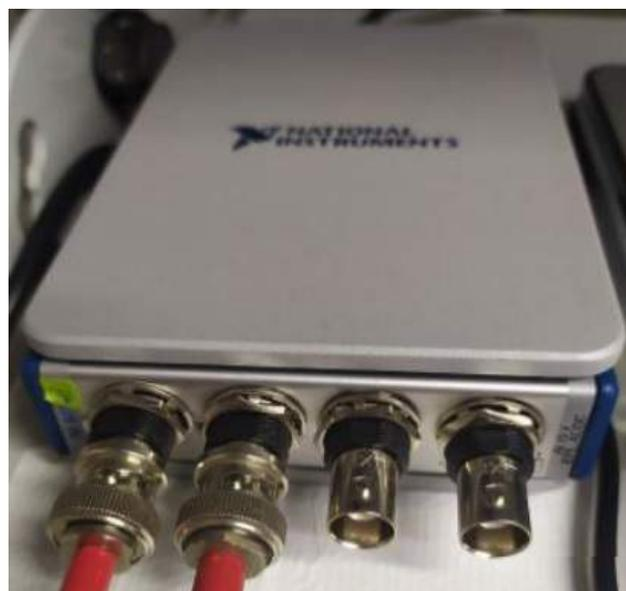
Figura A.5: Módulo cDAQ de 4 canais da *National Instruments - NI*, modelo 9234
