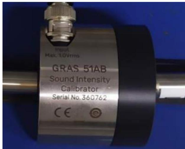
Figura A.4: Calibrador de intensidade sonora da *G.R.A.S Sound and Vibration*, modelo 51AB
