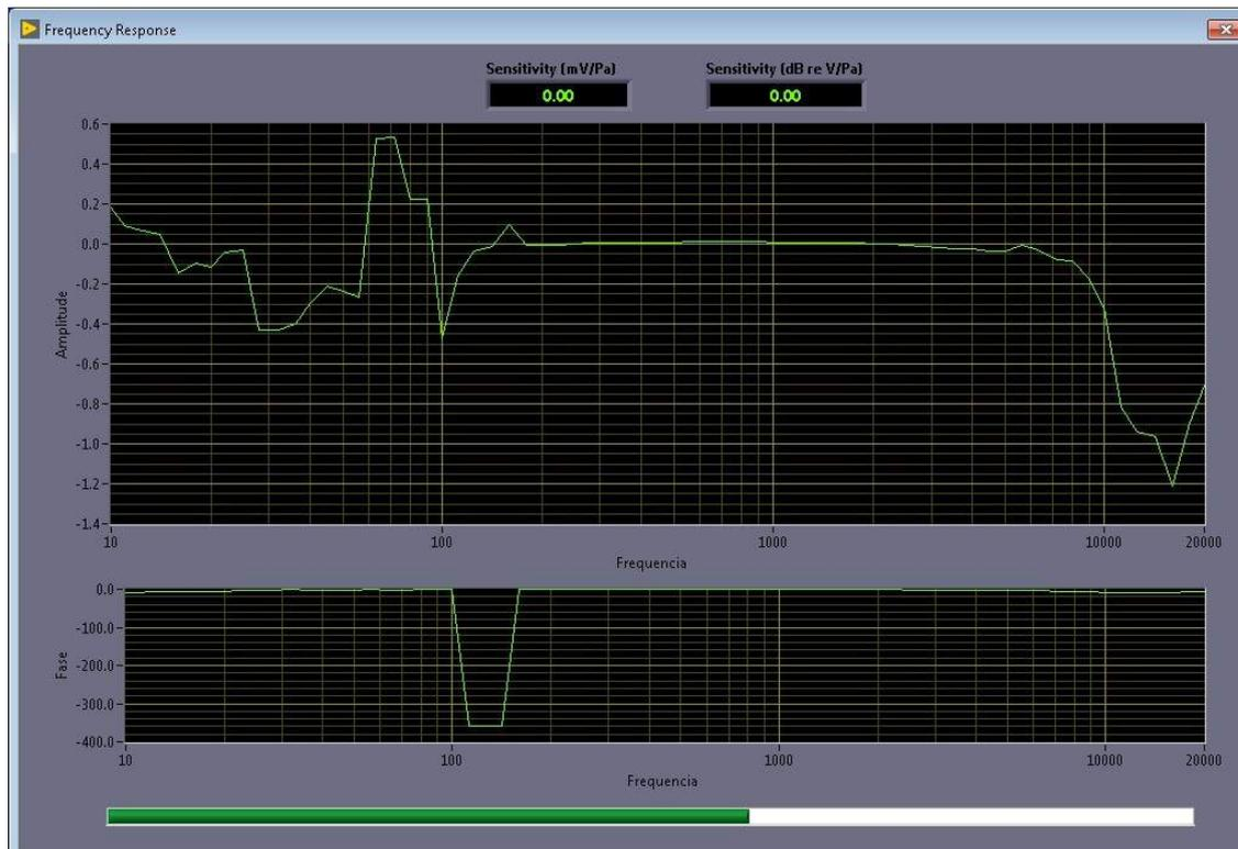
Figura 3.26: Diagrama de bode do microfone durante o *sweep* do gerador.
