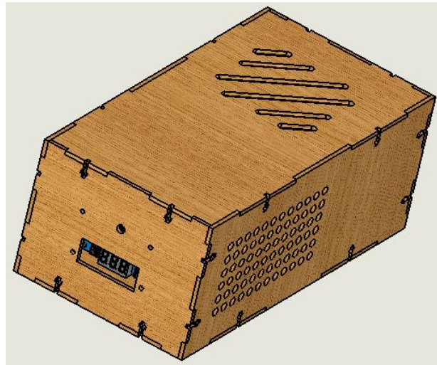
Figura 3.4 – Protótipo projetado para a fonte de alimentação
