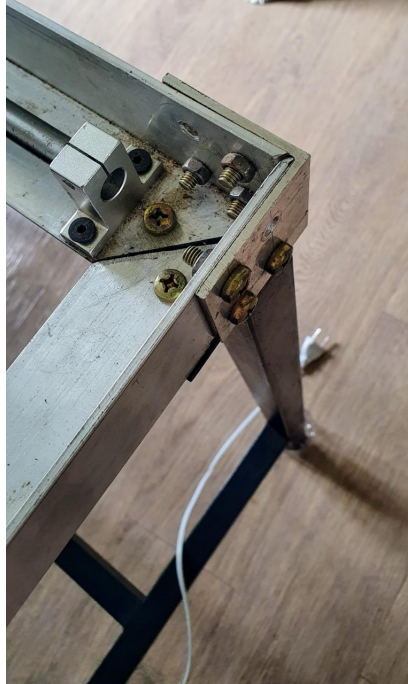
Figura 3.5 – Peça guia parafusada a estrutura em alumínio
