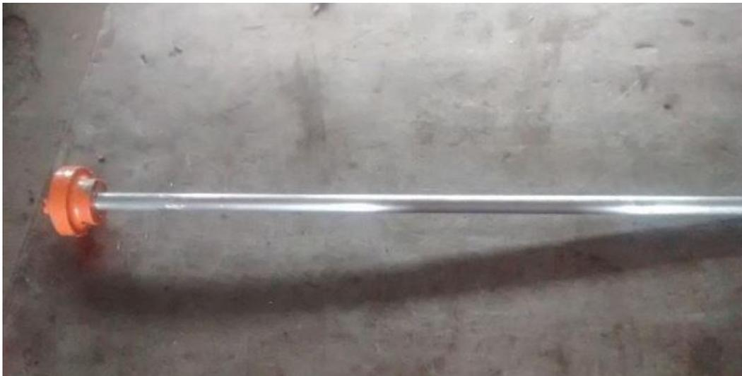
Figura 3.6: Eixo de aço carbono ABNT 1020. Fonte: FREITAS JÚNIOR (2015).
