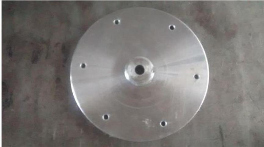
Figura 3.7: Disco de aço ASTM A36 com seis furos para colocação de massas desbalanceadoras. Fonte: FREITAS JÚNIOR (2015).
