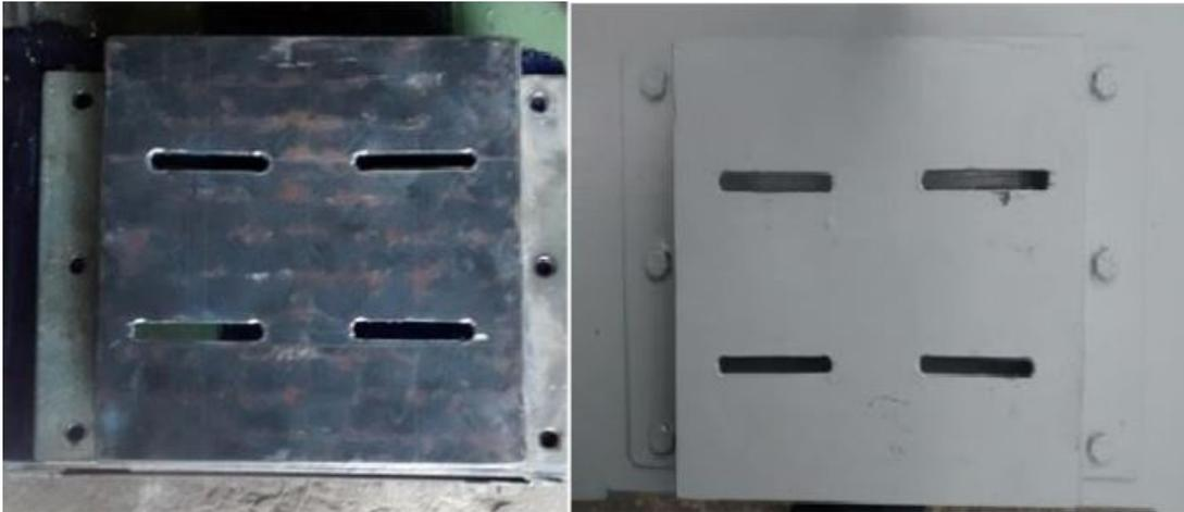
Figura 3.10: Base para posicionamento do motor. Fonte: FREITAS JÚNIOR (2015).
