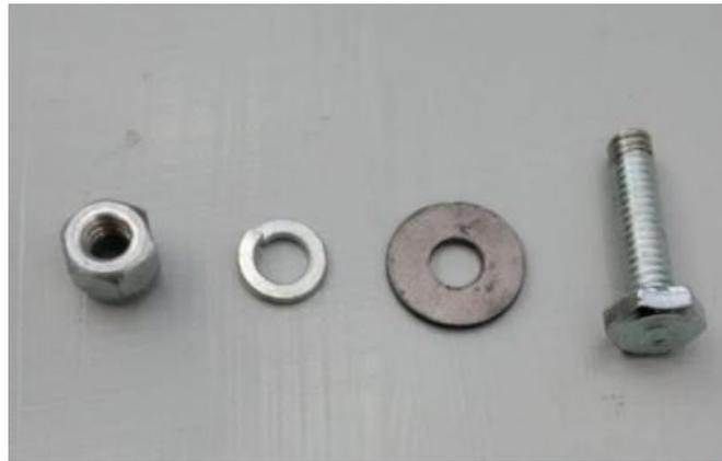
Figura 3.11: Elementos de fixação. Fonte: FREITAS JÚNIOR (2015).
