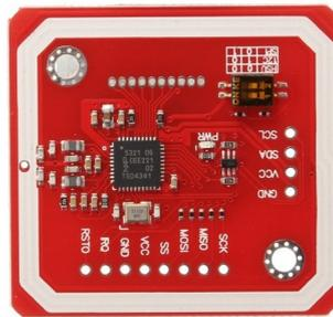
Figura 3.2: Módulo Leitor NFC PN532. Fonte: (FELIPEFLOP, 2021a)
