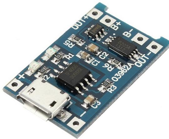
Figura 3.8: Módulo carregador de bateria. Fonte: (FELIPEFLOP, 2021f)
