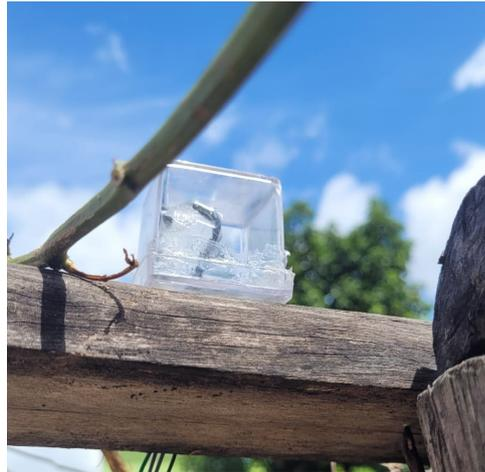
Figura 5.2 – Sensor Uv instalado - Fonte: Autor
