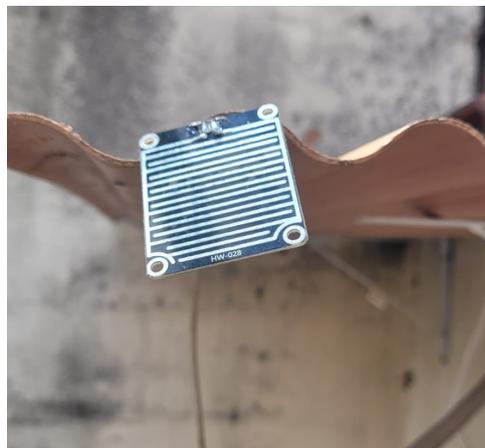
Figura 5.3 – Sensor chuva instalado - Fonte: Autor
