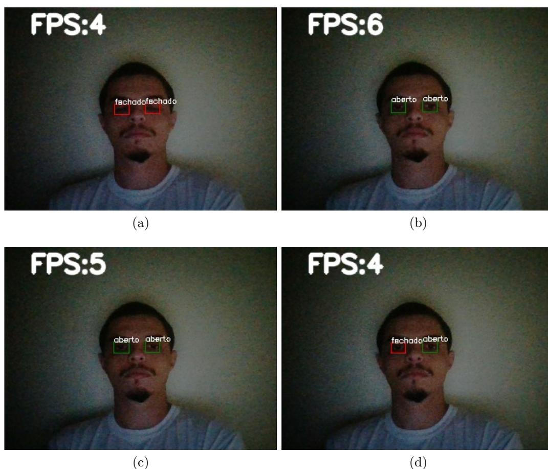
Figura 5.5: Recorte do *frame* para olho aberto (b), (c) e (d) e fechado (a)
