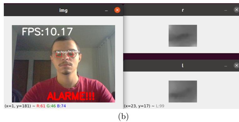
Figura 5.12: Teste embarcado para condutor com óculos
