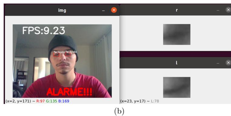
Figura 5.13: Teste embarcado para condutor com gorro
