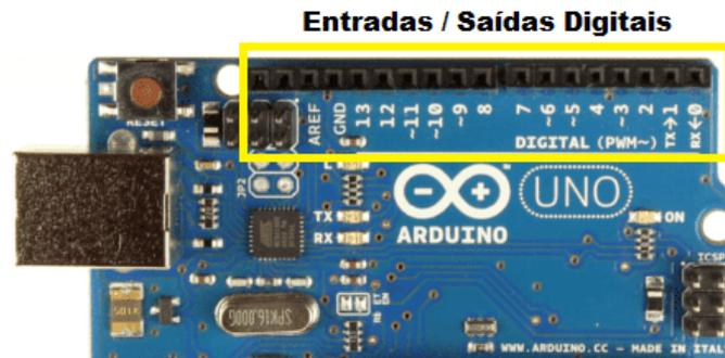
Figura 4.4: Entradas Digitais Fonte: Embarcados
