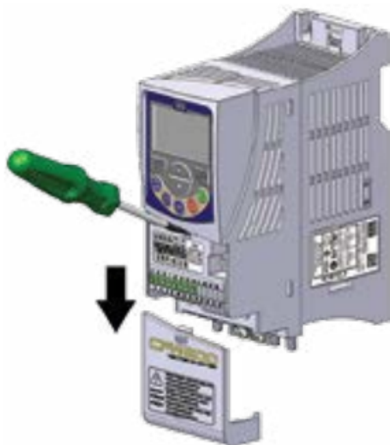
Figura 3.5 – Remoção da tampa frontal e do acessório
