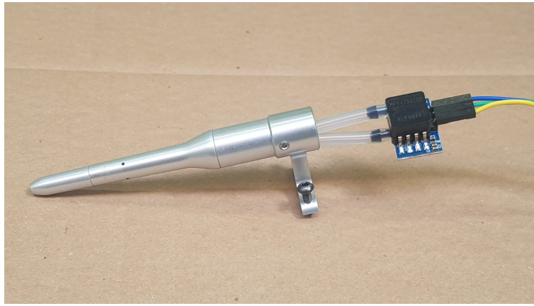
Figura 3.8: Sensor diferencial de pressão conectado ao tubo de Tubo de Pitot JMT-PT60 para medição da velocidade da aeronave.
