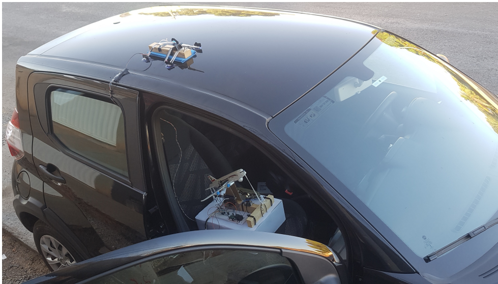
Figura 4.7: Fixação do sensor didático para a realização dos testes dos testes dinâmicos.
