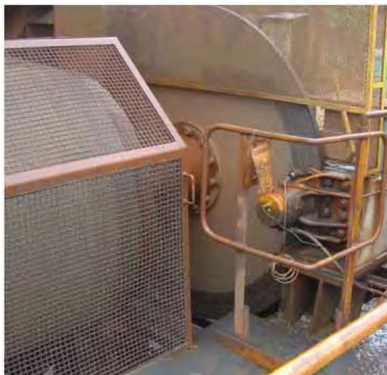
Figura 18: Freio instalado no eixo de baixa do transportador (Catálogo Sandvik).
