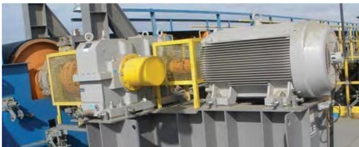
Figura 13: Conjunto de acionamento (Motor, acoplamento flexível de alta rotação, redutor, acoplamento flexível de baixa rotação e tambor motriz)
