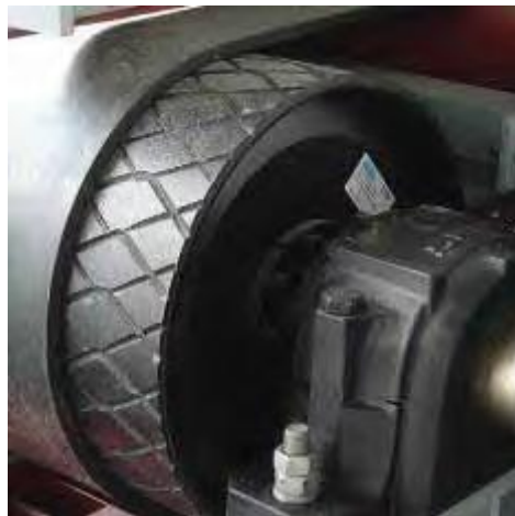
Figura 4: Tambor motriz com revestimento em cerâmica (Catálogo Sandvik).
