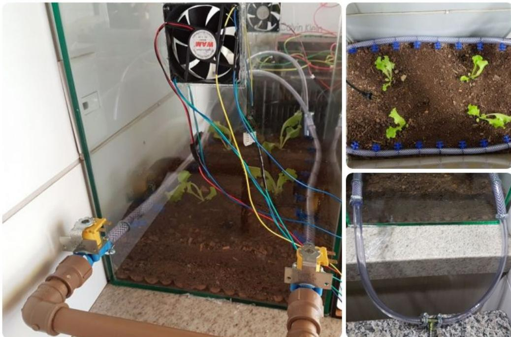
Figura 4.3: Sistema hidráulico fabricado
