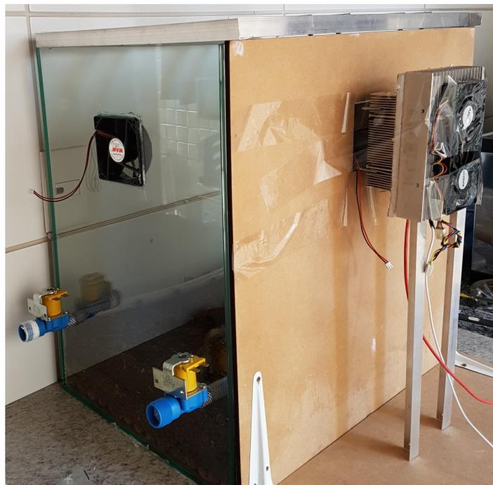
Figura 4.8: Afixação do sistema da pastilha de peltier
