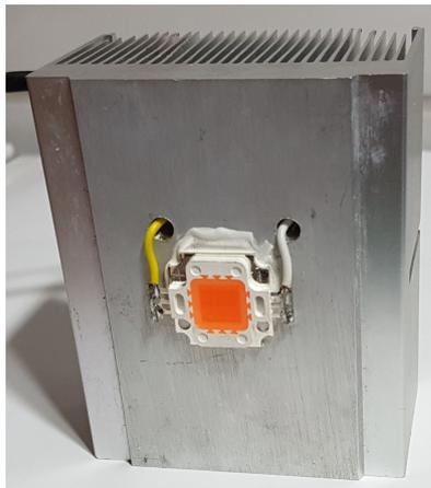
Figura 4.14: Conjunto LED + Dissipador
