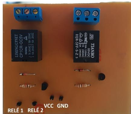
Figura 4.5: Placa para controle da irrigação pronta
