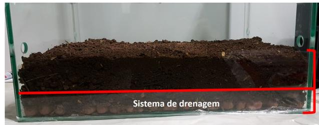
Figura 4.1: Sistema de drenagem Implementado
