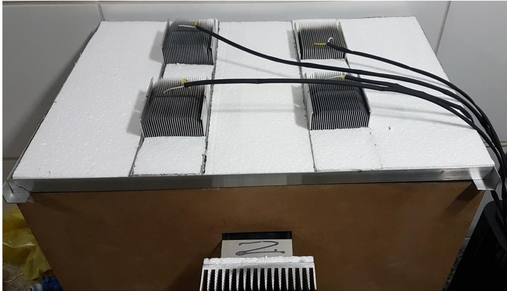
Figura 4.15: Suporte para os LEDs com placas de poliestireno
