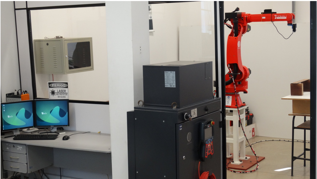
Figura 3.3 – Estrutura do laboratório: robô, controladora e Open LPC.
